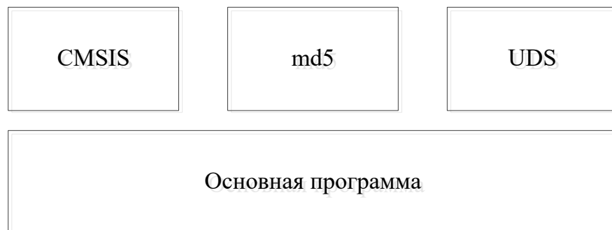
Рисунок 1 – Архитектура встроенного ПО bootLoaderMDR
